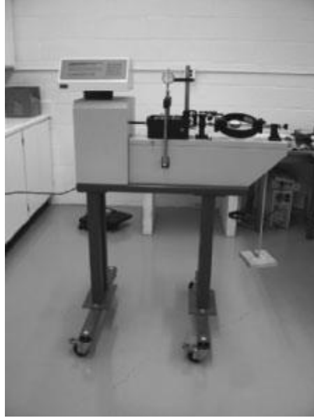
الشكل 12.5 جهاز القص المجهز بمعدات للتحكم بالتشوه (Courtesy of Braja M. Das, Henderson, Nevada)
